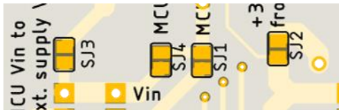
Figure 12: Ponts SJ1 à SJ4.
